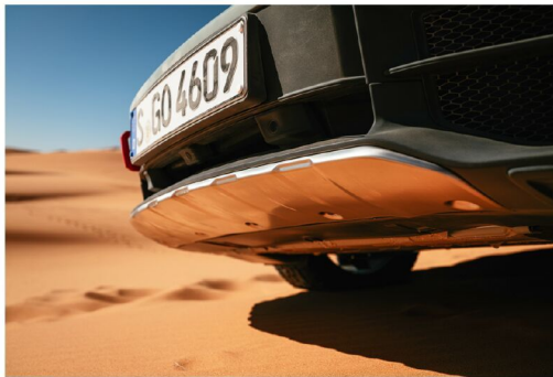
Unterfahrschutz und hoch gelegtes Fahrwerk. Der Offroad-Elfer verfügt über Zutaten, die bei der Baureihe 911 60 Jahre lang undenkbar schienen.
